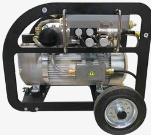
Автоматизированная 2-х канальная гидростанция ADG 17-3-Ex (во взрывозащищенном исполнении)
